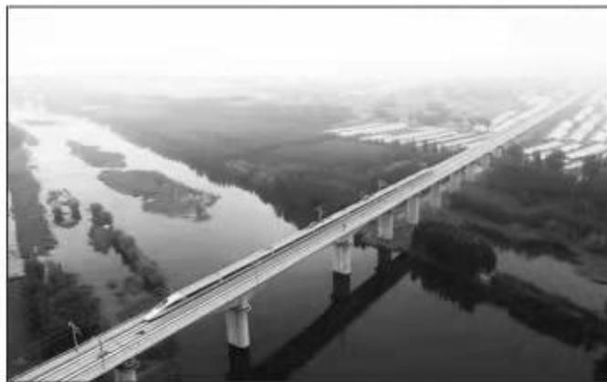
8月10日,CRH380AJ型高速综合检测列车以200公里的时速从济南高铁寿光段胶济河特大桥呼啸而过,这列被称为黄医生的动车组将对济青高铁的设计速度、通信及信号系统、客运服务系统等17大项内容进行全面测试。
